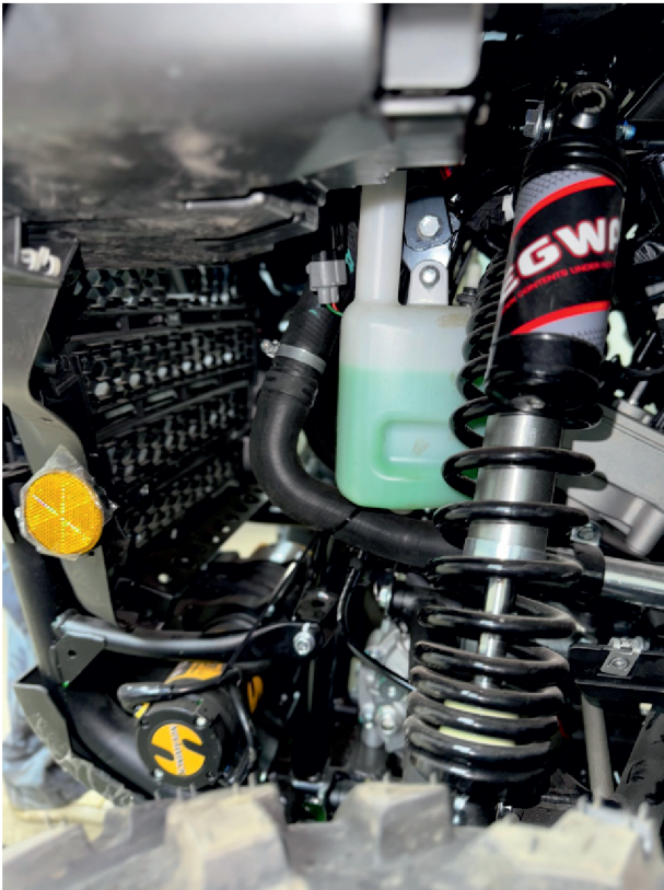
9. Расположение патрубков слева. Штатный патрубок стыкуется с патрубком 2190 из комплекта посредством прямого соединителя.
