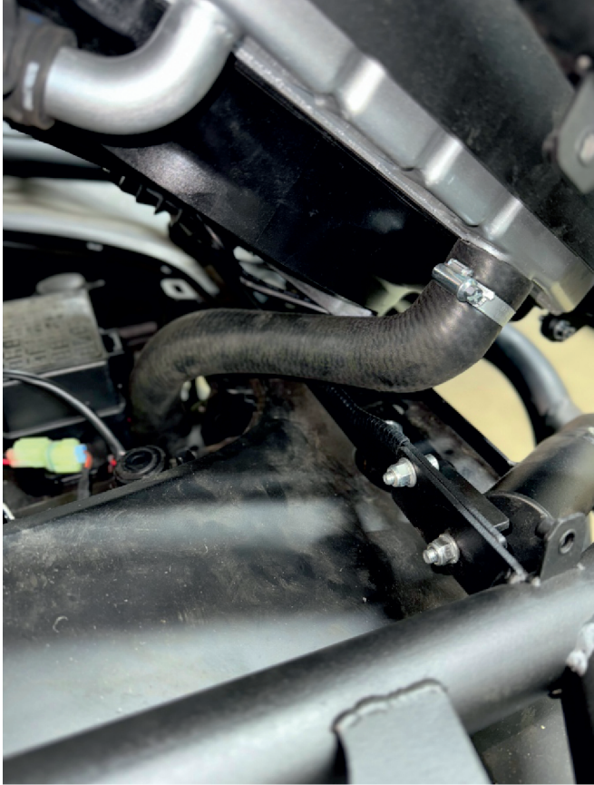
7. Схема подключения патрубков - с правой стороны стыкуются 2 патрубка из комплекта через прямой соединитель 2170 снизу справа, 2110 - справа сверху.
