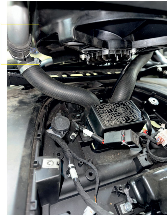
7. Схема подключения патрубков - с правой стороны стыкуются 2 патрубка из комплекта через прямой соединитель 2170 снизу справа, 2110 - справа сверху.
