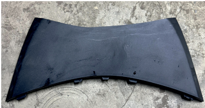
11. Обрезаем переднюю часть капота таким образом, чтобы он не упирался в патрубки, ставим на место.
