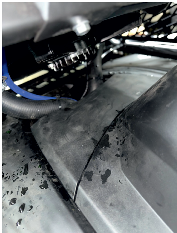
10. После подключения всех патрубков, соединяем расширительный бачок с горловиной сбросным шлангом, прокладывая его наиболее удобным способом без перегибов. Заливаем антифриз. При заливке рекомендуется снять штатный шланг с радиатора, выделенный на фото.
