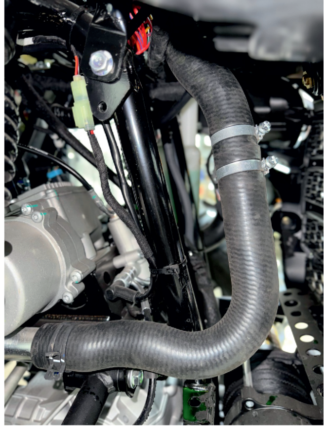
7. Схема подключения патрубков - с правой стороны стыкуются 2 патрубка из комплекта через прямой соединитель 2170 снизу справа, 2110 - справа сверху.
