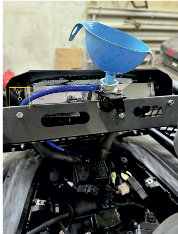
10. После подключения всех патрубков, соединяем расширительный бачок с горловиной сбросным шлангом, прокладывая его наиболее удобным способом без перегибов. Заливаем антифриз. При заливке рекомендуется снять штатный шланг с радиатора, выделенный на фото.
