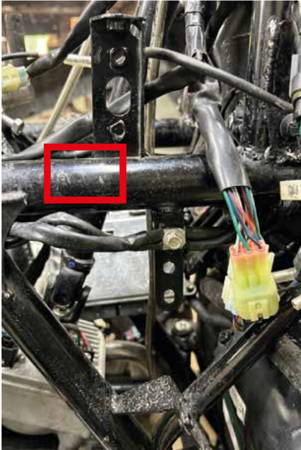
17. Крепление массы пучка проводов переносим на раму в указанное на фото место, предварительно зачищаем место крепления до металла.
