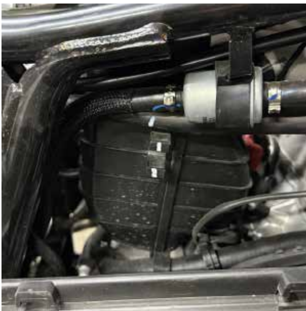
10. Перед прокладкой воздухопроводов требуется удалить крепеж на корпусе фильтра и срезать угол на пластике, шланг вентиляции поднимаем выше к топливопроводу.
