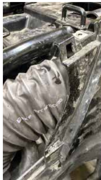
10. Перед прокладкой воздухопроводов требуется удалить крепеж на корпусе фильтра и срезать угол на пластике, шланг вентиляции поднимаем выше к топливопроводу.
