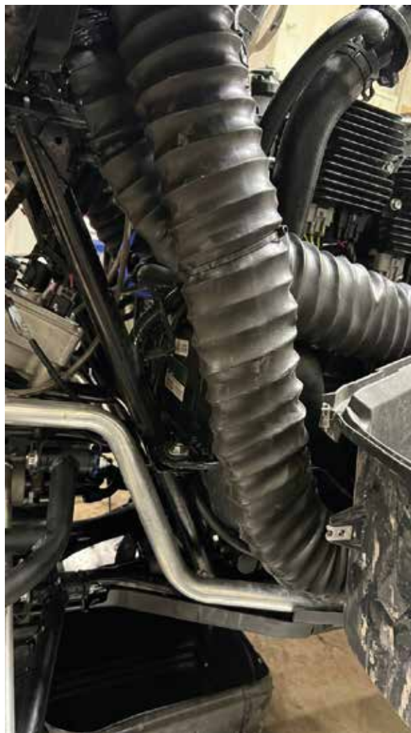
13. Схема прокладки дальнего впуска вариатора. При прокладке фиксируем воздуховод нейлоновыми стяжками.
