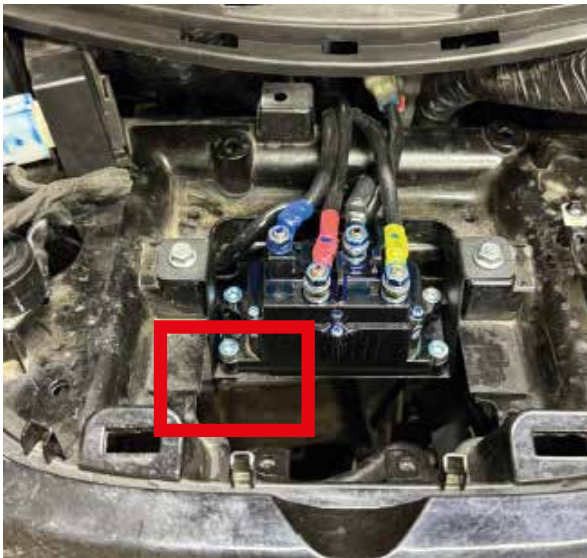
17. Крепление массы пучка проводов переносим на раму в указанное на фото место, предварительно зачищаем место крепления до металла.
