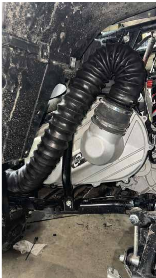
13. Схема прокладки дальнего впуска вариатора. При прокладке фиксируем воздуховод нейлоновыми стяжками.
